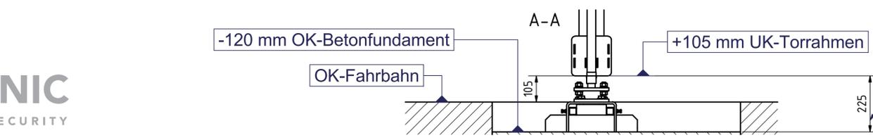
Der Abstand zwischen UK-Tor und OK-Betonfundament beträgt 225 mm. Wir empfehlen 105mm Luft zwischen Fahrbahn und UK-Tor, daraus ergibt sich, dass das Fundament 120mm unterhalb der fertigen Fahrbahn liegt. Geländebedingt kann der Abstand zwischen Fahrbahn und Toranlage auf minimal 50mm verringert werden.
